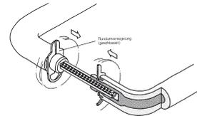
Festdrehbarlagerung mit selbsttätig einrastender Rundumverriegelung.
