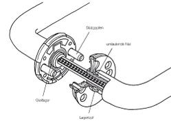
Doppellagerung als wartungsfreies Gleitlager mit elastischem Ausgleichsbereich. Die zweite Lagerstelle im Drückerhals erhöht die Führungsqualität und Dauerbelastbarkeit. Lockerungssichere Verschraubung.
