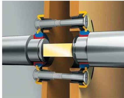
FSB AGL-Beschläge garantieren, dass die an viel begangenen Türen auftretenden axialen und vertikalen Kräfte abgefangen werden. Dies gilt insbesondere für den Einsatz in
